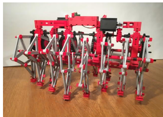
Abb. 8: fischertechnik-Strandbeest (Version 2) mit acht Beinpaaren (Aufbau Abb. 4 b), angetrieben von zwei S-Motoren.
