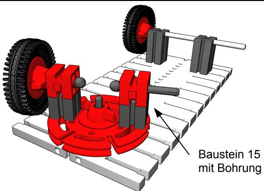
Bild 6a Drehschemel mit geteilten Achsen
