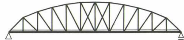
31.5 SCHWEDLER-Träger, alle Diagonalen haben nur Zugbeanspruchung. (Nicht mehr ausgeführt.)
