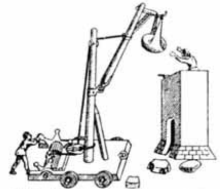
7.5 Baukran mit schwenkbarem Ausleger nach Taccola
