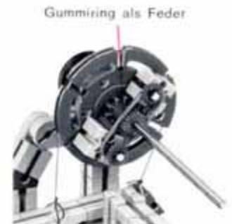
22.4 Baustufe 4 zu Modell 25.1 (2 Klinken mit Feder)
