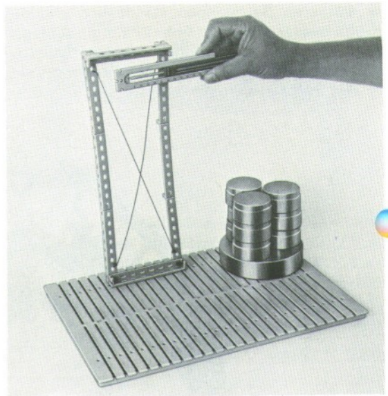
Abb. 24 Bereits die Diagonalverspannung mit Schnüren erbringt eine erhebliche Stabilisierung; jedoch ist hier nur in einer Ebene stabilisiert.
