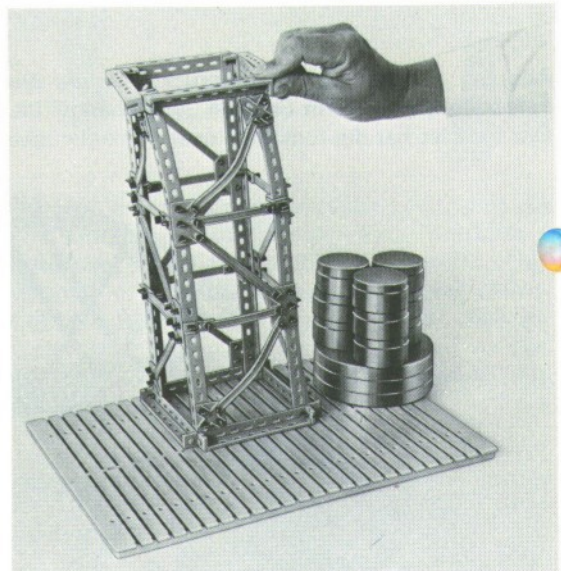
Abb. 26 Bei sehr starkem (mit dem Kraftmesser nicht mehr meßbarem) Druck auf eine Ecke können mehrere statische Funktionen einsichtig gemacht werden. Deutlich ist zu sehen, wie der Druck von rechts die obere Strebe biegt (Knickbelastung). Dasselbe geschieht an der unteren Strebe. Gegenkräfte erbringen entweder weitere Streben, die dann auf Zug belastet, den Druck abfangen oder Winkelträger, die sich nicht verformen. Der gesamte Turm ist bei dieser Belastung torsionsbeansprucht.
