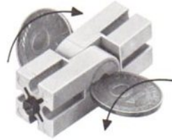
Abb. 4.14 „Werkzeug“ zum Lockern der Gelenkverschraubung
