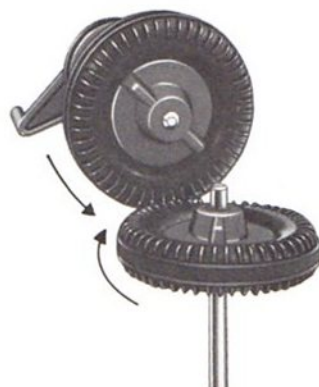
Abb. 4.41 bis 4.42 Das Zahnrad 40 Z als Winkelzahnrad und Stirnzahnrad
