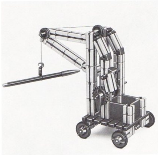
Abb. 3.7.15 Fahrbarer Kran mit starrem, abgestützten Ausleger. Ein Baustein 30 dient als Sperrklinke. Der Kasten aus Flachbausteinen kann die Gegengewichte aufnehmen.
