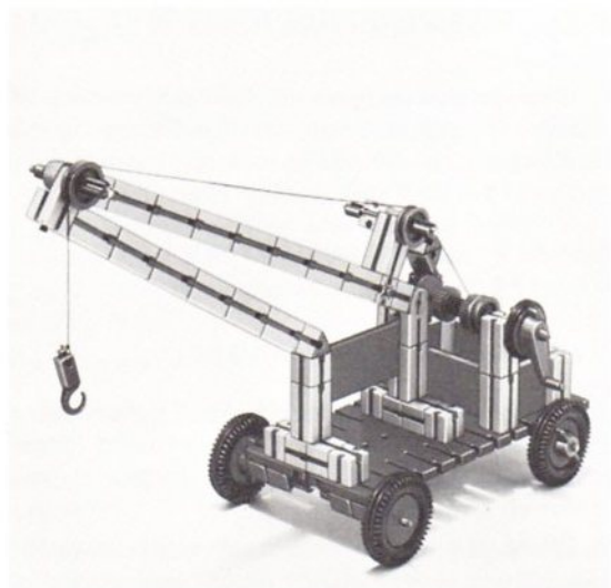
Abb. 3.7.12 Kran wie auf Abb. 3.7.11. Die Abbildung zeigt u. a. die Konstruktion der Achslager aus Winkelsteinen.
