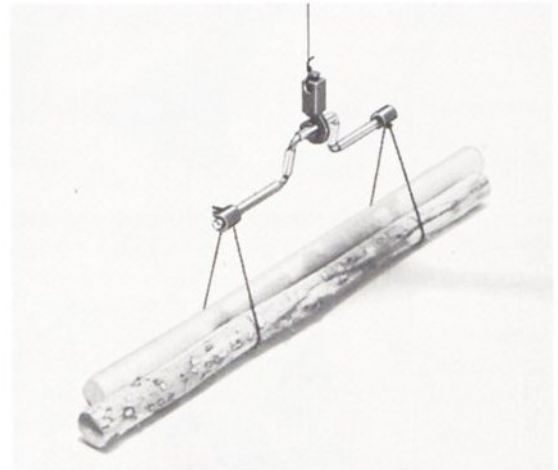
Abb. 3.7.28 Die Seile werden unter den „Baumstämmen“ durchgezogen und dann an der Kurbelwelle befestigt.
