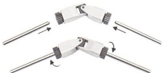
Abb. 4.30 Montage des Kardangelenks
