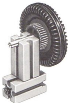
Abb. 4.54 Verlängerung von Stangen durch die Achskupplung
