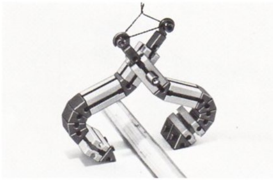
Abb. 3.7.30 und 3.7.31 Selbsttätig schließende Greifer zum Aufnehmen von „Baumstämmen“.
