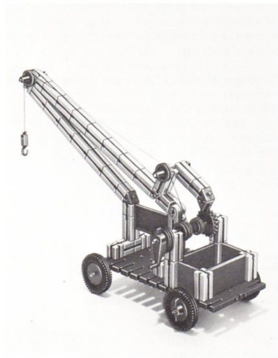
Abb. 3.7.11 Fahrbarer Kran mit starrem, abgestützten Ausleger. Die Handkurbel dient zum Antreiben der Welle der Seiltrommel. Die Führung des Hubseils erfolgt durch Schnurlaufrollen. Die Sperrklinke verhindert ein ungewolltes Absinken der Last. Der Kasten aus Flachbausteinen kann die Gegengewichte aufnehmen, er dient gleichzeitig der Stabilisierung der Hubvorrichtung.
