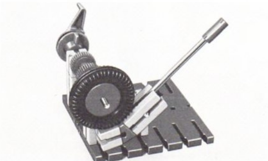
Abb. 3.7.34 Konstruktionsbeispiel einer Außenbackenbremse.
