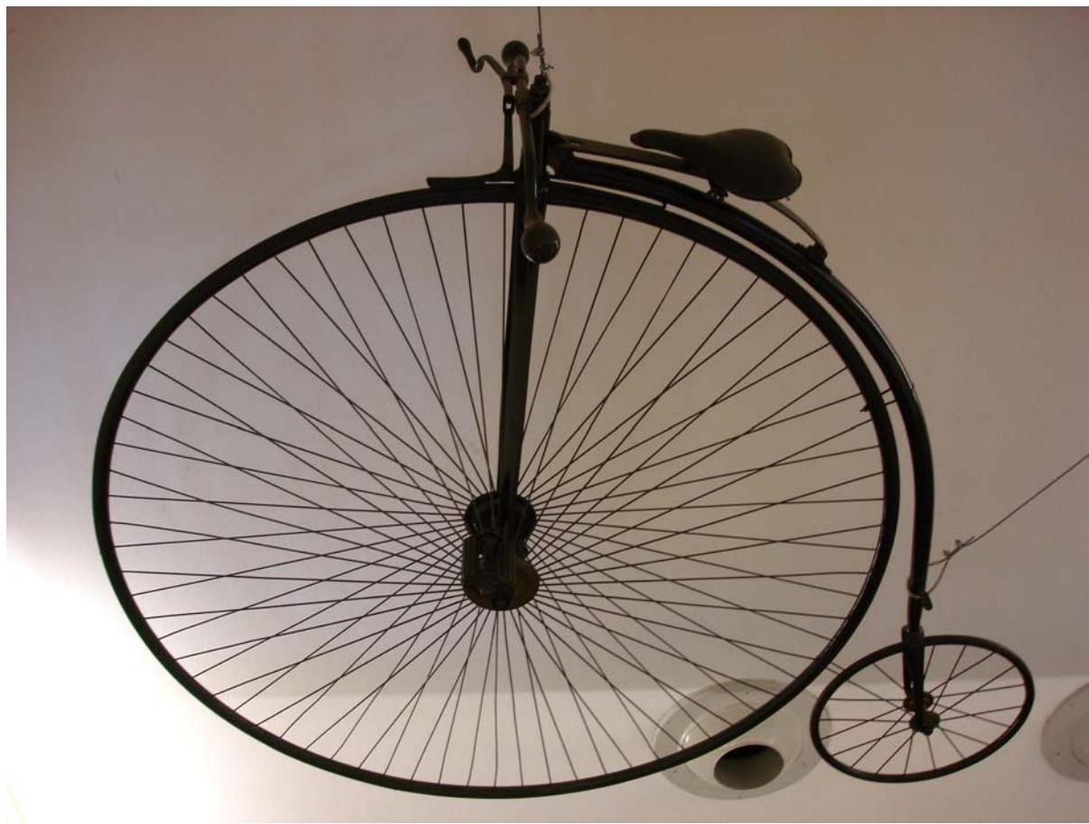
Durch das größere Antriebsrad kann eine höhere Geschwindigkeit erreicht werden (Hochrad 1870). Der Fahrer saß jedoch sehr hoch und konnte dadurch leicht nach vorne kippen. Dadurch häuften sich die Unfälle.
