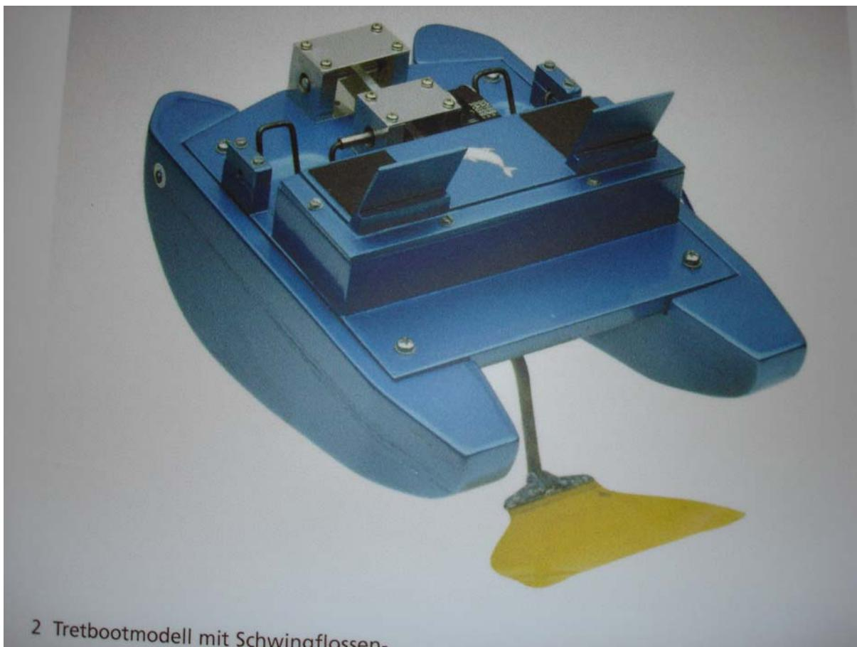
Der Wirkungsgrad ist beim Flossenantrieb deutlich höher (86% gegenüber bestenfalls 60 – 70 % beim Propellerantrieb)
