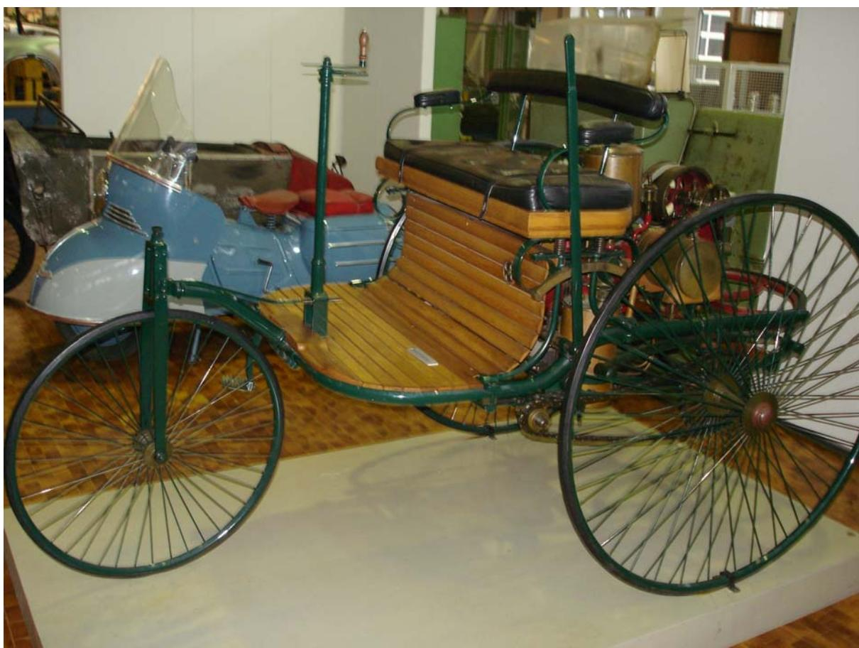
Durch Drehen der Handkurbel, an deren Welle sich am anderen Ende ein Zahnrad befindet, das eine Zahnstange vor- und zurückbewegt und damit das über ein Gelenk verbundene Gestänge des Vorderrads nach links und rechts dreht.
