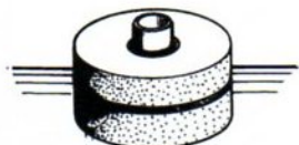
Mühlsteine (die Bewegung wird um 90° geändert)
